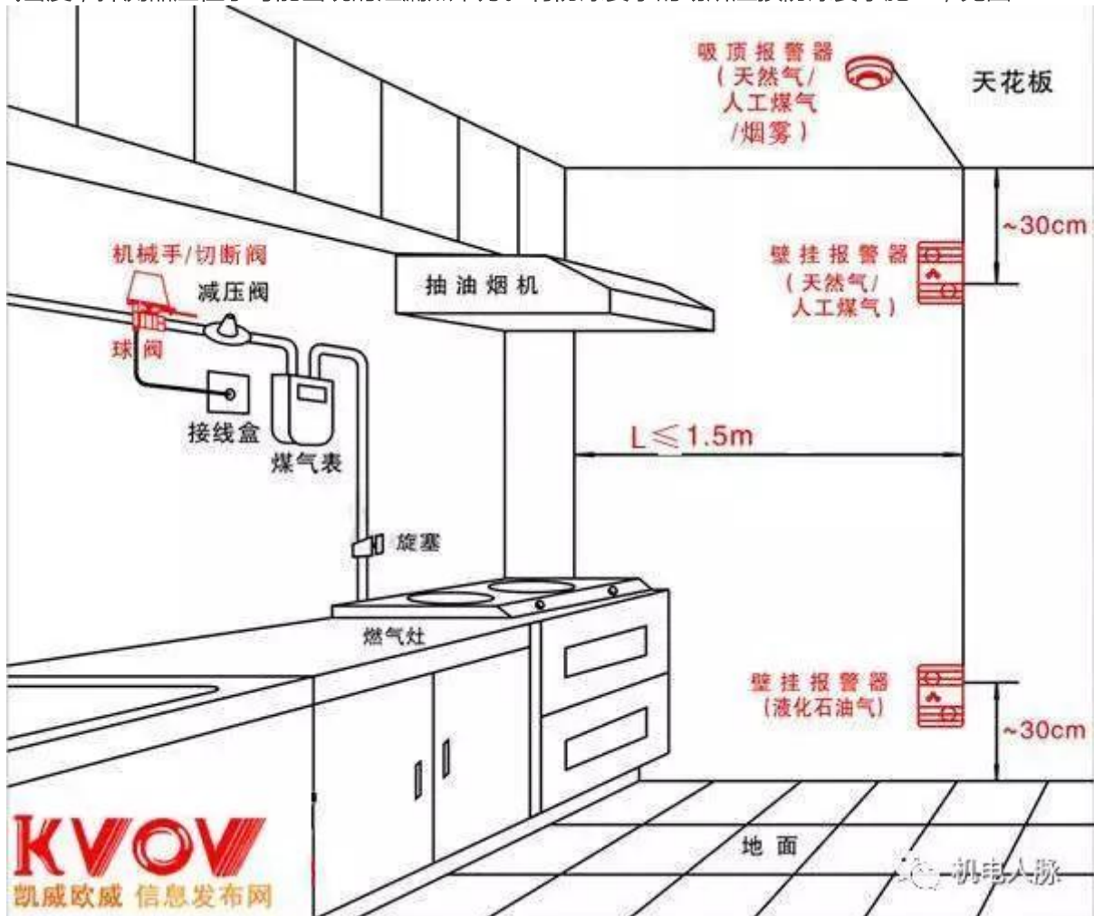
图6.2.2-3 可燃气体探测器安装
